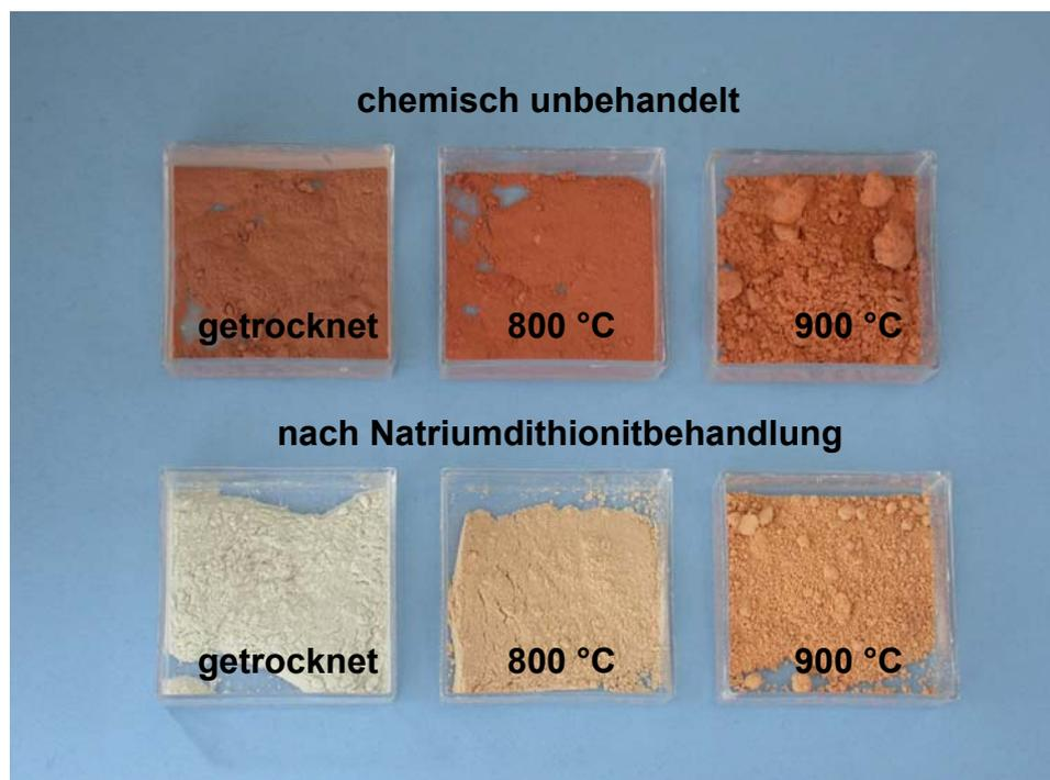
Abb. 19: Gegenüberstellung unterschiedlich thermisch behandelter Tonpulverpräparate, Ton rf 84, < 2 µm fraktioniert.
