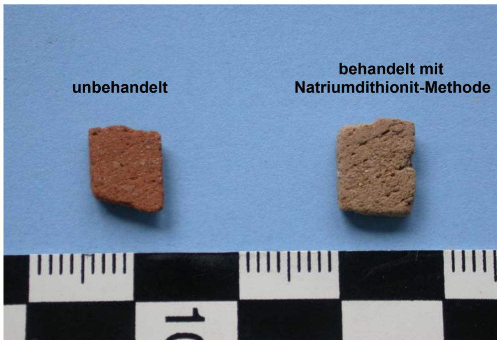
Abb. 20: Gegenüberstellung einer unbehandelten und einer chemisch behandelten Probe aus historischem Ziegelmaterial (Probe LAT ZG 1, Landshut, Burg Trausnitz).
