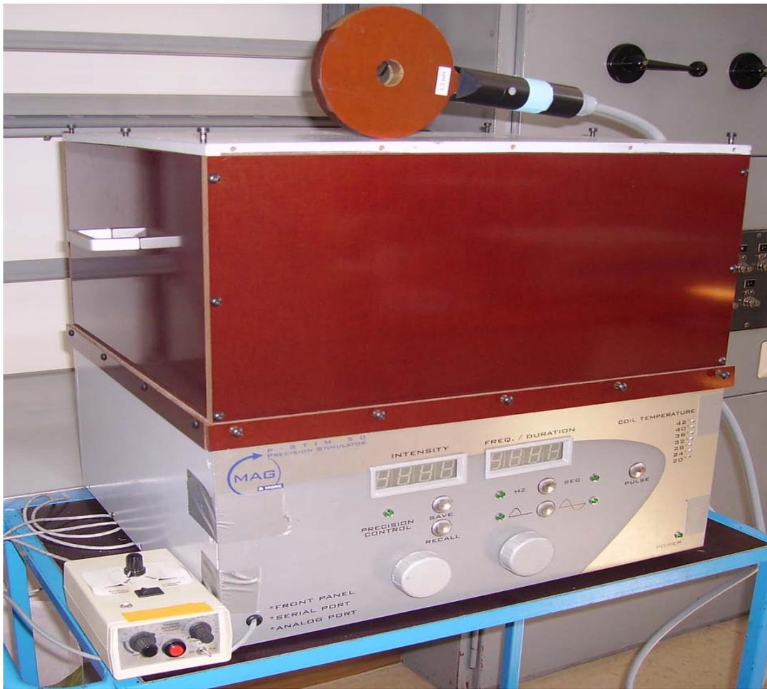
Abbildung 8.3: Ansicht des verwendeten Stimulators (Mag'n'More GmbH, München). Grundgerät mit einem speziell entwickelten Aufsatz für längere Pulse und höhere Durchflutungen (Kondensatorbatterie).
