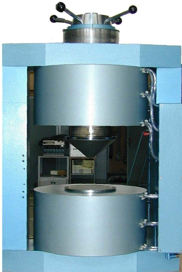
Abbildung 7.5: Fotografie des fertigen Großtiermagneten.
