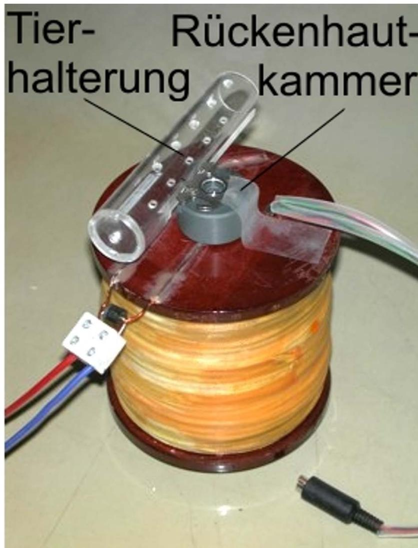
Abbildung 7.7: Foto des Kleintiermagneten mit Tierhalterung.
