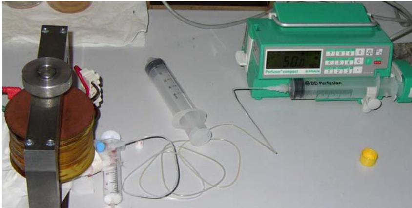
Abbildung 11.16: Versuchsaufbau zur Durchführung von Retentionsexperimenten in realen Arterien.
