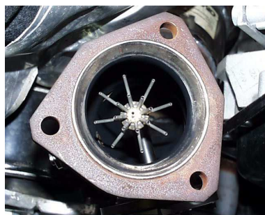
Bild C.1: Vorrichtung zur Verteilung des Reduktionsmittels \text{NH}_3 aus einem Abgasteil- mit dem Hauptstrom. Aus Herr [2004].
