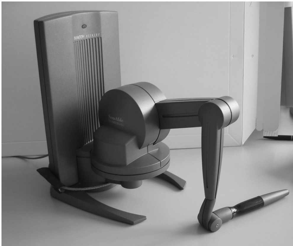
Abbildung 3-4: Eingabegerät PHANTOM® Desktop™ der Firma SensAble™
