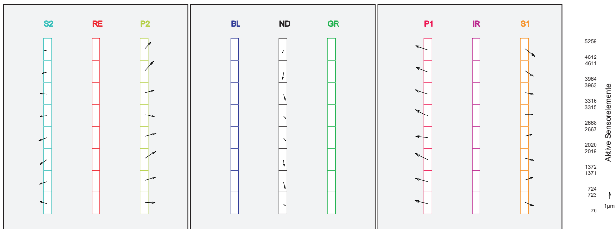
Abbildung 6.1. Mittlere Restabweichungen in den Bildkoordinaten nach der Ausgleichung ohne verbesserte Parameter der inneren Orientierung
