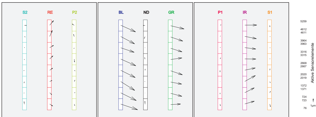
Abbildung 6.10. Mittlere Restabweichungen in den Bildkoordinaten nach der Ausglei- chung aller Sensoren mit verbesserten Pa- rametern der inneren Orientierung für die Sensoren ND, S1 und S2
