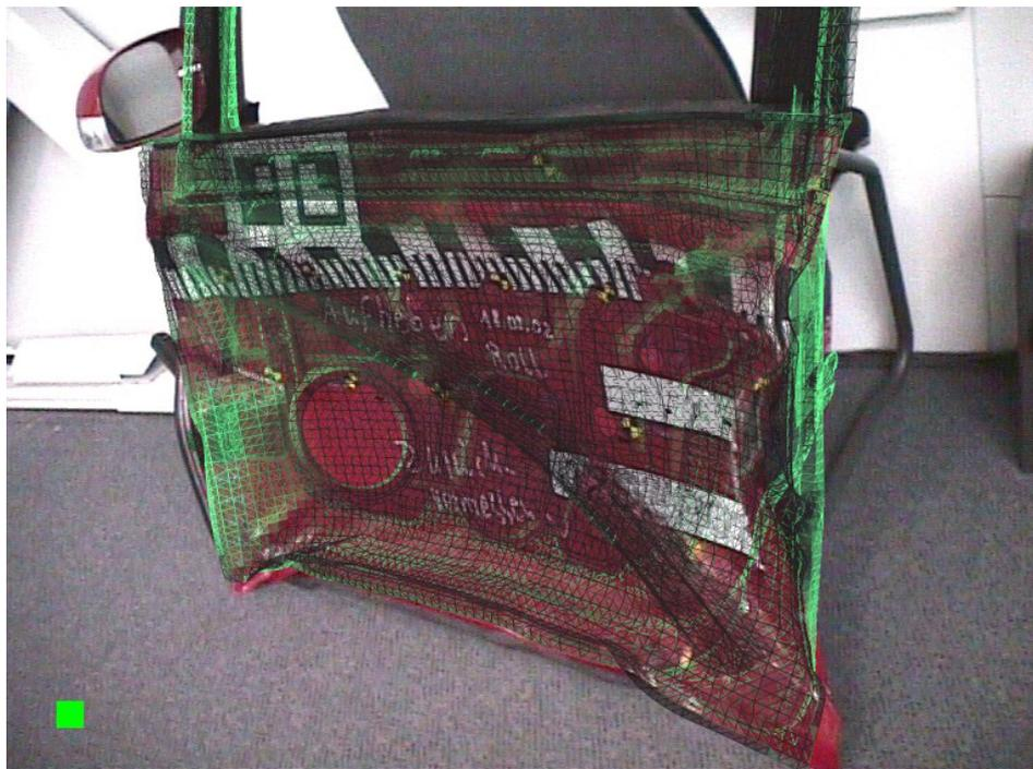
Abbildung 2.3: Crashtür mit augmentiertem FEM Berechnungsergebnis
