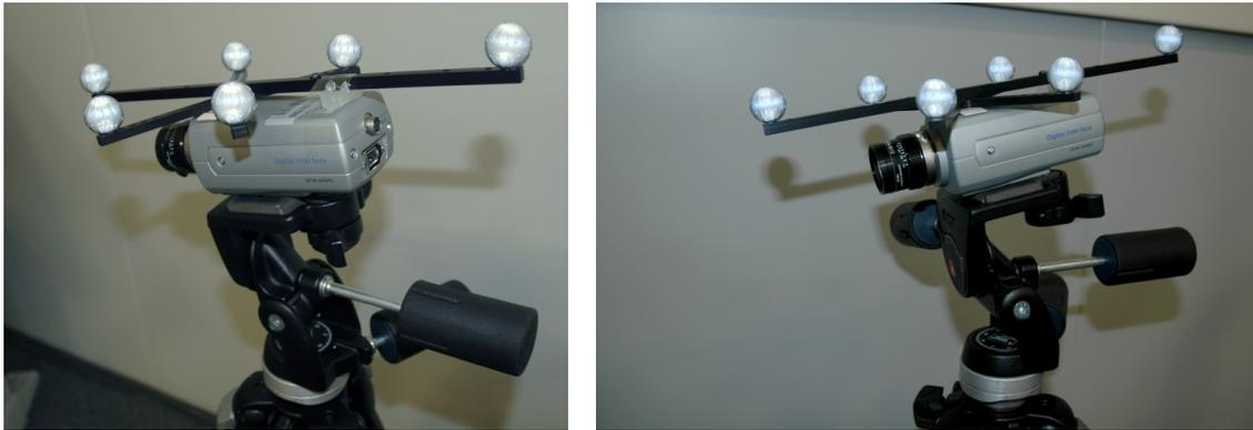
Abbildung 7.2: Sony Videokamera mit montiertem Rigid Body
