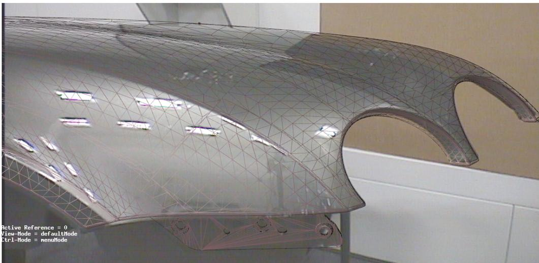
Abbildung 4.18: Ungenaue Objektregistrierung eines Kotflügels
