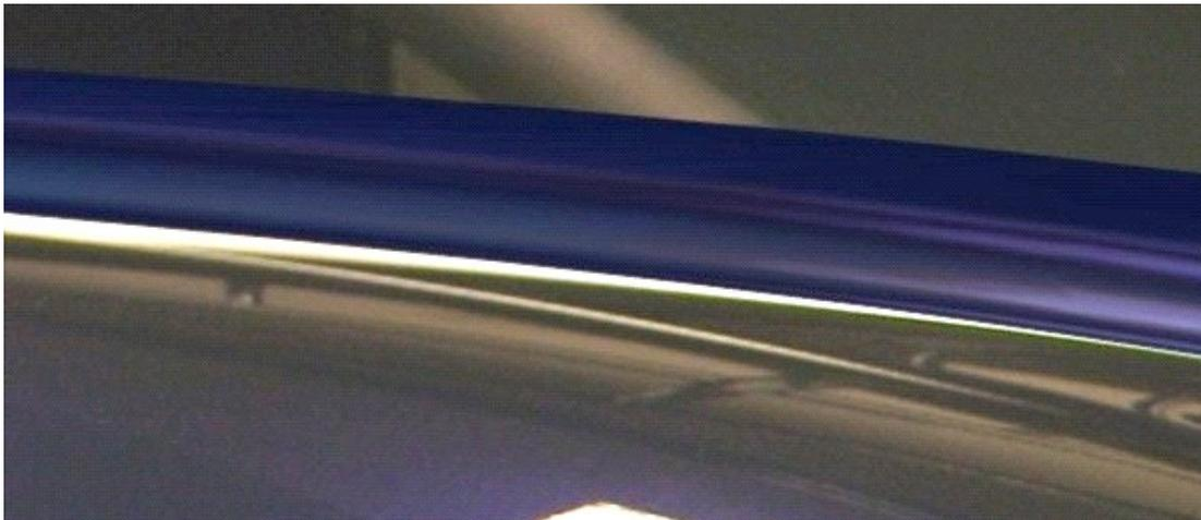
Abbildung 5.18: Spalt am Kotflügels im linken Bereich (beleuchtet)
