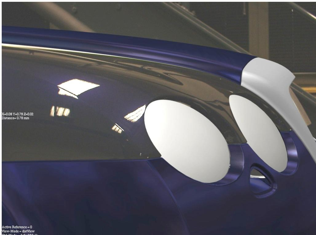
Abbildung 5.17: Frontpartie des Kotflügels mit überlagerten Anbauteilen
