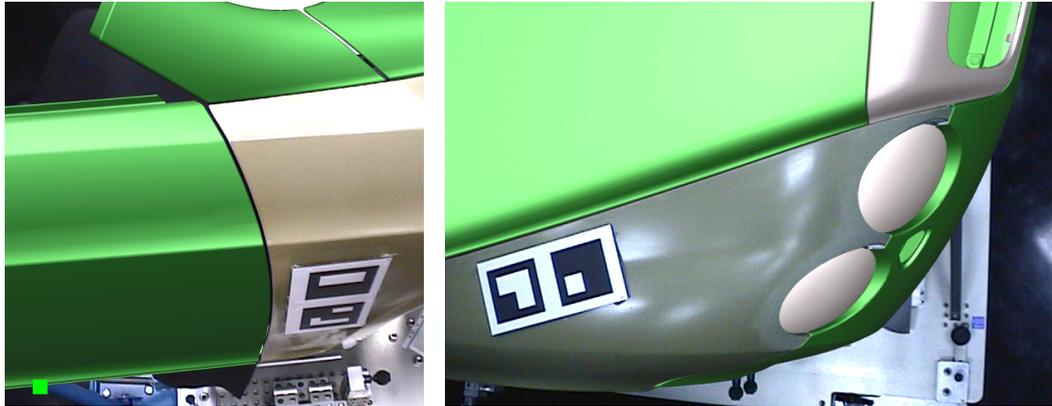
Abbildung 2.2: Realer Kotflügel mit virtuellen Anbauteilen
