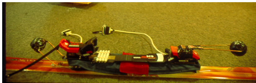
Abbildung 17: Skibindung mit Kraftsensoren und Markerpunkten
