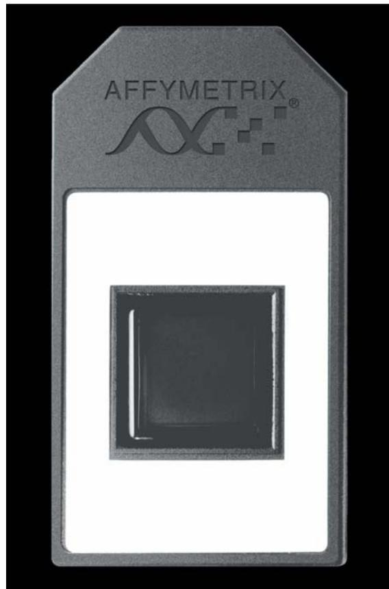
*Abbildung 3-17: Mikroarray-Genchip der Firma Affymetrix. In dem quadratischen Feld in der Mitte des Chips befinden sich Gensequenzen, an die fluoreszenzmarkierte Gensequenzen aus der zu untersuchenden DNA binden können. Die Anzahl gebundener Gensequenzen kann fluoreszenzoptisch gemessen werden. Quelle: Affymetrix.*
