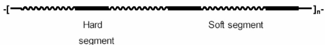
**Abbildung 3-2:** Abfolge von harten und weichen Sequenzen in thermoplastischem Polyurethan (nach [67]).
