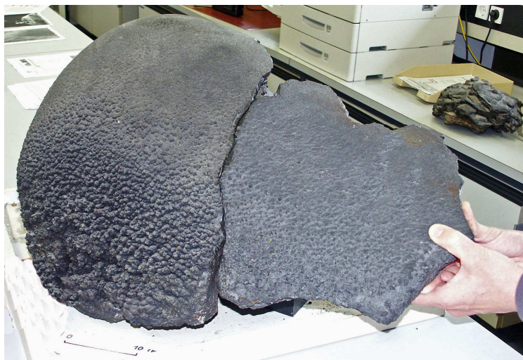
Abbildung 4.6: Ein Stück der Mangankruste 237KD vom Zentralpazifik aus einer Tiefe von ca. 4830 m.
