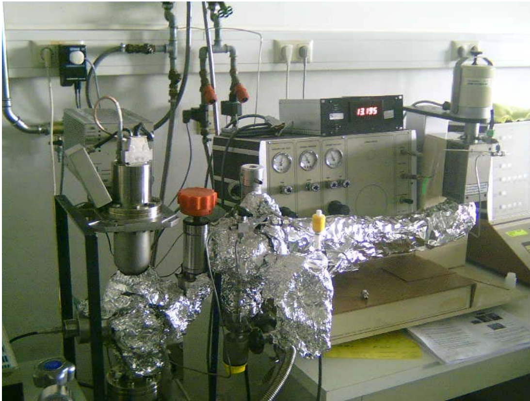
Figure B.2: Experimental set-up for adsorption isotherm measurements at the Institut für Technische Chemie 2 of the Technische Universität München.
