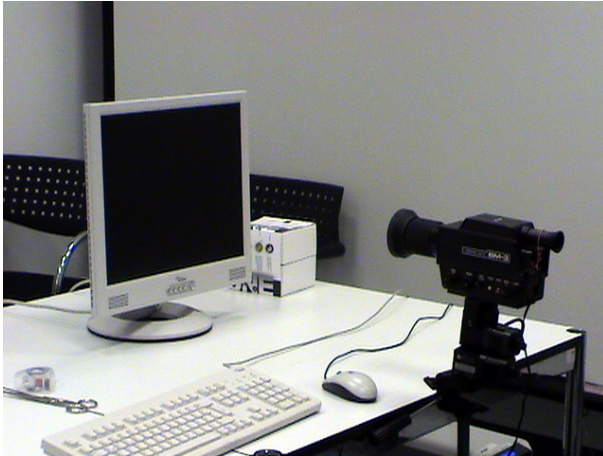
Abbildung 7.3: Vermessung eines TFT-Displays
