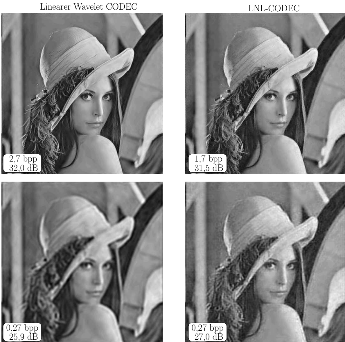
Abbildung 4.11: Vergleich der Kodierleistung des linearen Referenz-Codec mit der LNL-Architektur.
