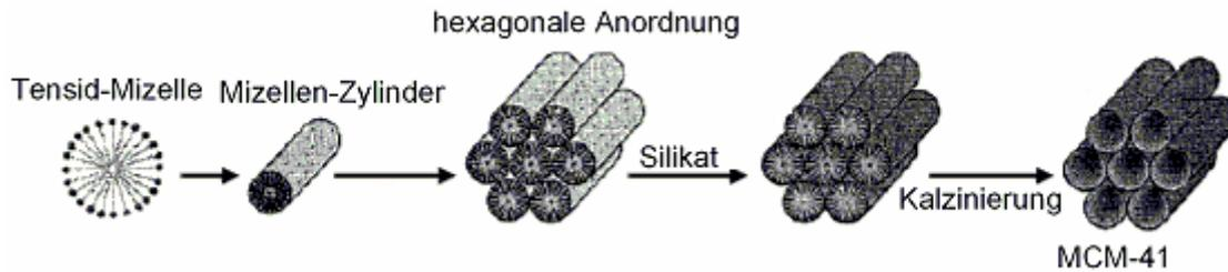
**Schema A 2:** Reaktionsschema der MCM-41 Synthese: die Mizellen-Zylinder liegen bereits als hexagonale Anordnung vor und bilden nach der Zugabe der Silica-Vorstufe und der Kalzinierung das poröse MCM-41-Material.
