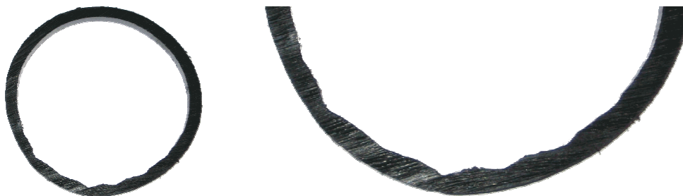
Abbildung 4.3: Querschnittsteil eines PE-HD Hüllrohrs nach Belastung (Umlenkung)
