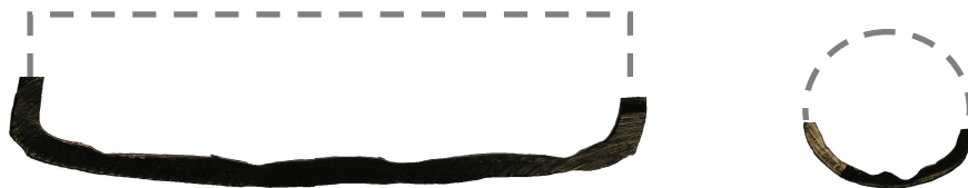
Abbildung 4.1: Querschnittsteile von äußerer (links) und innerer Ummantelung (rechts) nach Belastung (Umlenkung) eines Bandspannglieds
