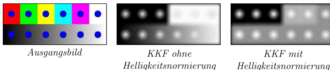
Abbildung 2.8: Anwendung der Kreuzkorrelationsfunktion auf den Blau-Anteil des Ausgangsbildes mit und ohne vorheriger Helligkeitsnormierung
