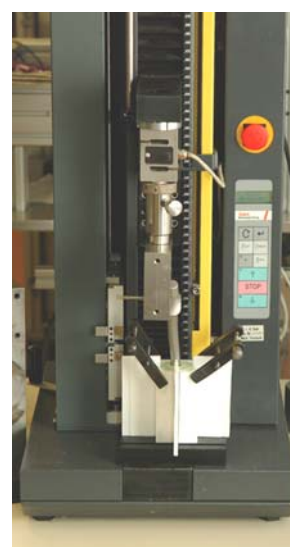
Abb. 3.5: Vorrichtung zur Herstellung der Zementköchler.
