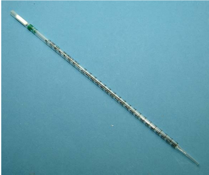
Abb 3.2A: Beim Versuch zum Partikelverlust im Zusammenhang mit Falcon®-Röhrchen verwendete serologische Pipette.
