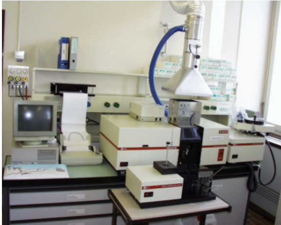
Abb. 3.10: Atomabsorptionsspektrometer Spectr AA 30/40 Zeeman, Fa. Varian, Darmstadt.
