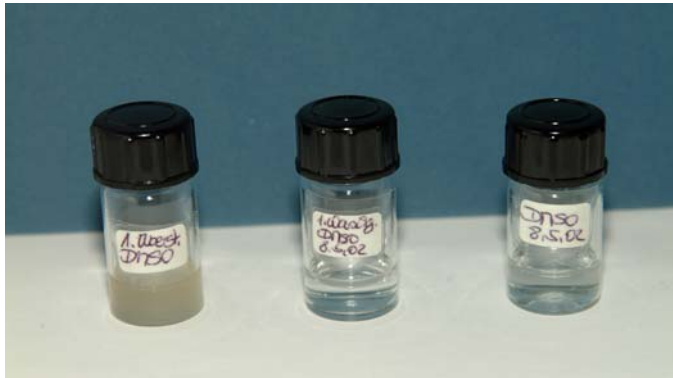
Abb. 4.14: Aufbereitungsschritte des Abriebpulvers eines glatten CoCr28Mo6-Stiels, gelaufen gegen Knochenzement mit ZrO_2 , zur Eliminierung des Knochenzements. Links: Erster Überstand. Mitte: Erster Waschgang. Rechts: reingewaschene Probe.
