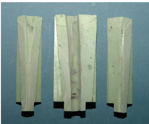
Abb. 4.2: Zementköcher nach Prüfung. Palacos ® R mit ZrO_2 nach Testung gegen rauen TiAl6Nb7-Stiel (links) bzw. Palacos R ohne ZrO_2 nach Testung gegen glatten CoCr28Mo6-Stiel rechts).
