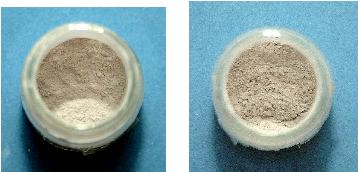
Abb. 4.9A: Native, in der Grenzfläche Endoprothesen-Stiel-Knochenzement generierte Abriebpulver. Links: Von rauem CoCr28Mo6-Stiel, gelaufen gegen niedrigviskös Knochenzement Sulcem ® 3. Rechts: Von rauem CoCr28Mo6-Stiel, gelaufen gegen hochviskös Knochenzement Sulcem ® 1.
