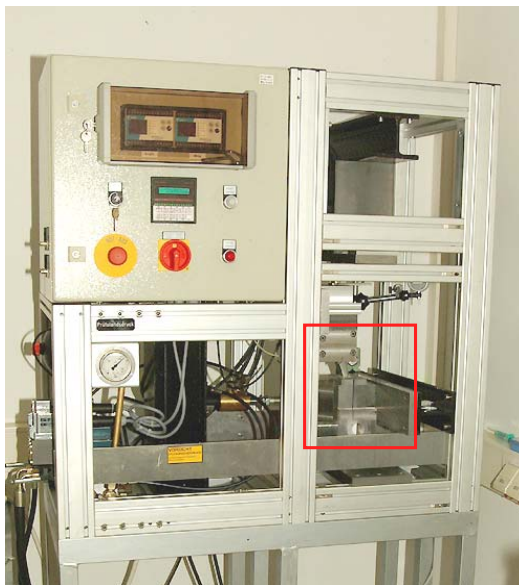
Abb. 3.1: Prüfstand zur Partikelerzeugung. Markierter Bildausschnitt siehe Detailvergrößerung in Abb. 3.2.
