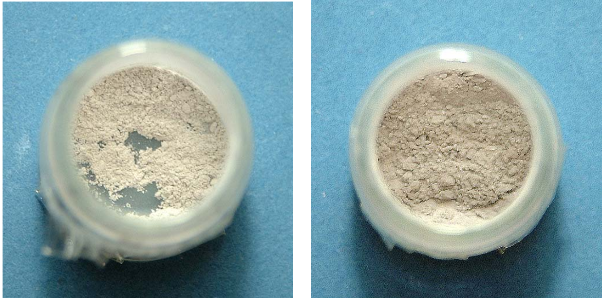
Abb. 4.8A: Native, in der Grenzfläche Endoprothesen-Stiel-Knochenzement generierte Abriebpulver. Links: Von rauem TiAl6Nb7-Stiel, rechts: Von rauem CoCr28Mo6-Stiel, beide gelaufen gegen Knochenzement CMW 2000 mit BaSO 4 .
