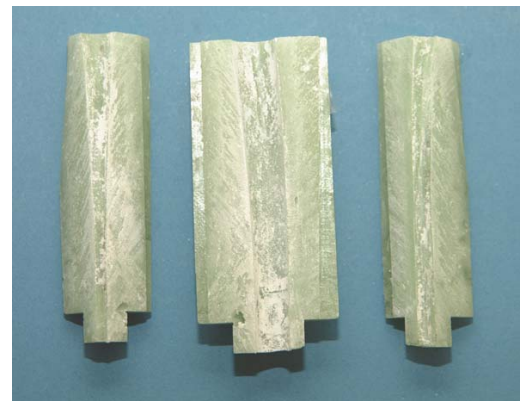
Abb. 4.2: Zementköcher nach Prüfung. Palacos ® R mit ZrO_2 nach Testung gegen rauen TiAl6Nb7-Stiel (links) bzw. Palacos R ohne ZrO_2 nach Testung gegen glatten CoCr28Mo6-Stiel rechts).
