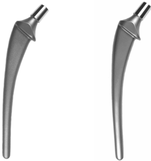
Abb. 3.6: Prüfobjekte im Ausgangszustand: anatomische Hüftendoprothesen-Stiele aus TiAl6Nb7 (links) und CoCr28Mo6 (rechts).
