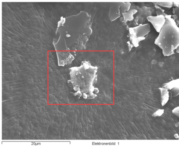
Abb. 4.19A: REM-Aufnahmen des aufbereiteten Abriebpulvers eines rauhen TiAl6Nb7-Stiels, gelaufen gegen Knochenzement ohne ZrO 2 . Links: In 2.000-facher Vergrößerung. Rechts: Detailausschnitt in 5.000-facher Vergrößerung.
