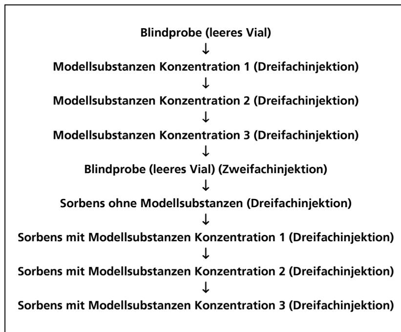
Abbildung 3-3: Beispielhafter Ablauf einer Messung mit der Headspace-Methode
