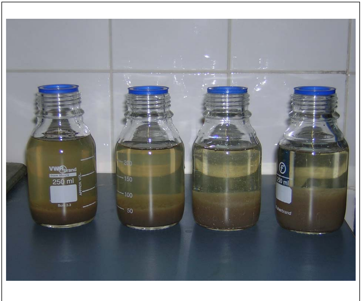
Abbildung 35: Beispiel eines Fällungs- und Flockungsversuchs mit unterschiedlichen Einsatzkonzentrationen.
