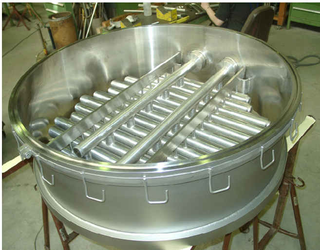
Abbildung 6.6: Werksfoto und 3D-Graphik - Register mit Zwischenring zum Einbau in den vorhandenen Filter
