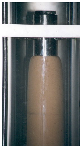
Abbildung 4.18: Flaschenhalseffekt am oberen Kerzenende
