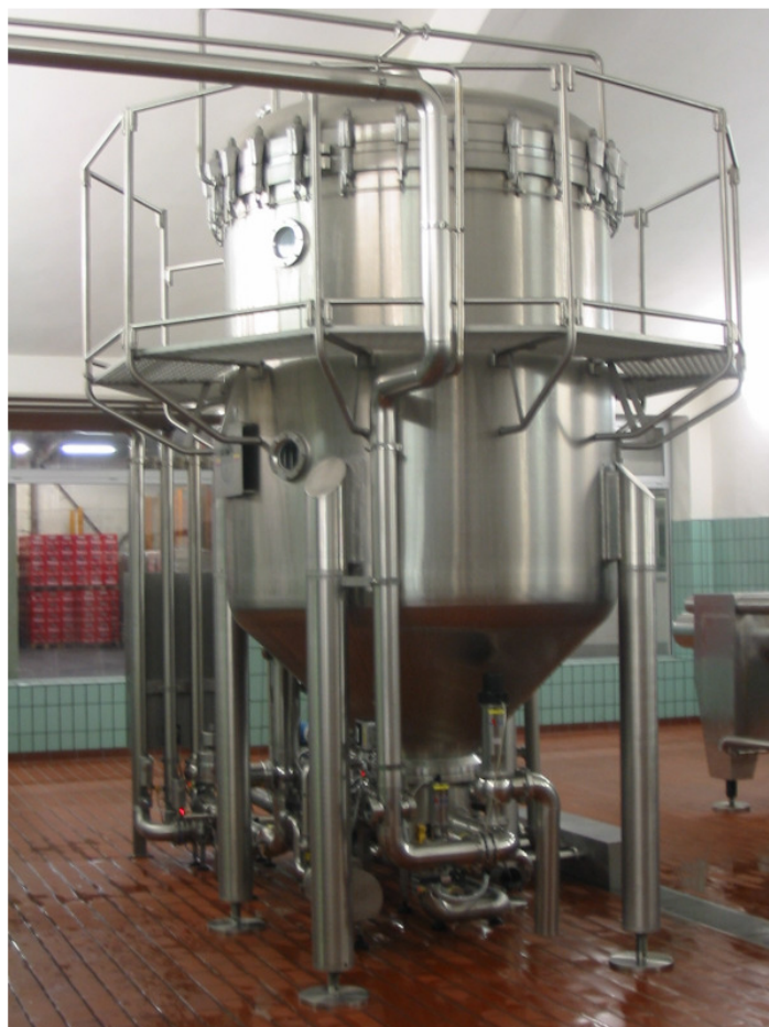
Abbildung A.4: Klassisches Kerzenfiltersystem der Firma Filtrix AG
