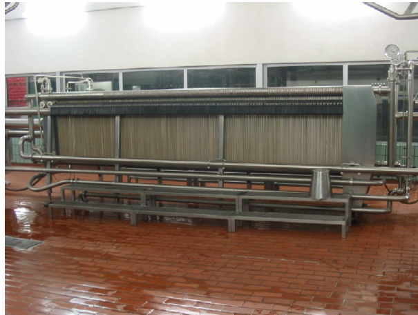
Abbildung 3.16: Schichtenfilter der Firma Seitz für eine Leistung von 400 hl/h
