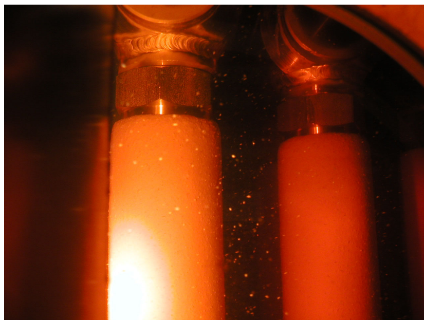
Abbildung 6.8: Anschwemmung oben bei einer Kerzenlänge von 2400 mm
