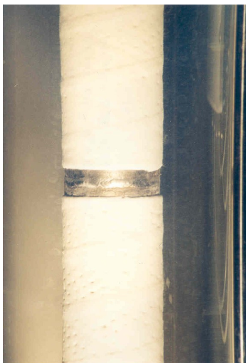
Abbildung A.9: Filterversuchstand mit ausgebauter, angeschwemmter Filterkerze
