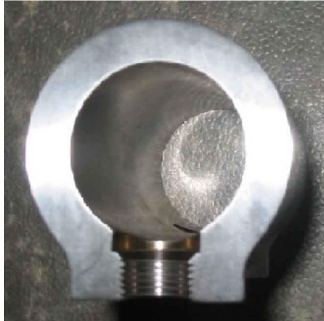
Abbildung 4.31: Sammelrohr mit Gewinde für Filterelement – Querschnitt
