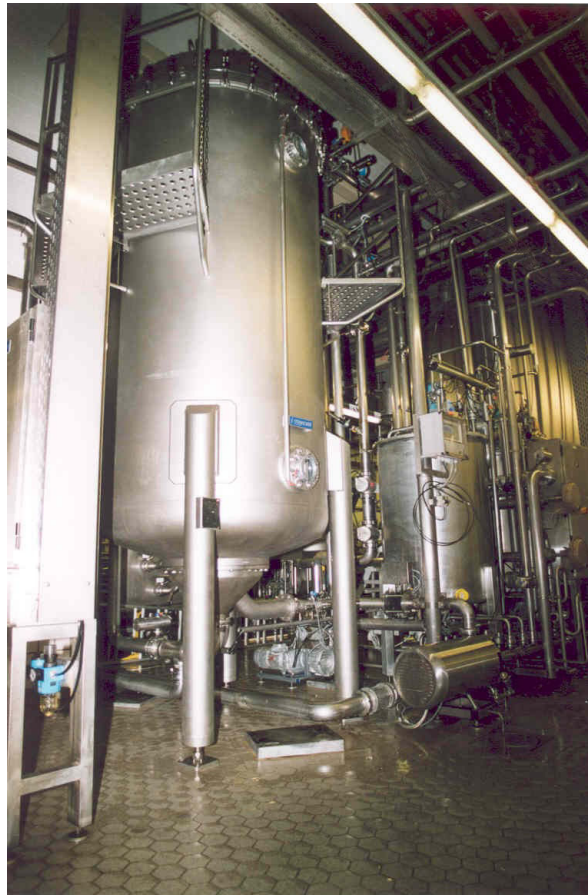
Abbildung 6.3: TFS-Filter mit einer Leistung von 400 hl/h
