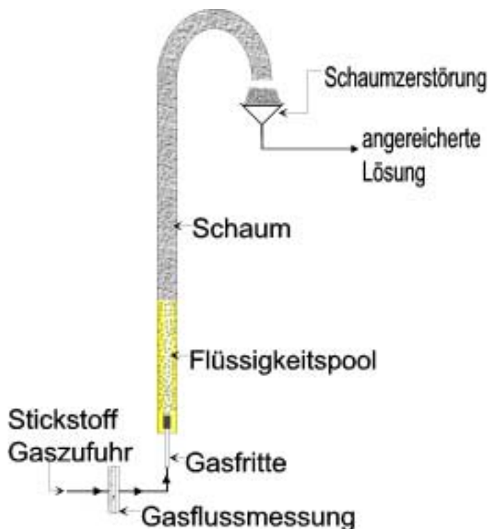
Abb. 2.5: Prinzip einer Zerschäumungsapparatur
