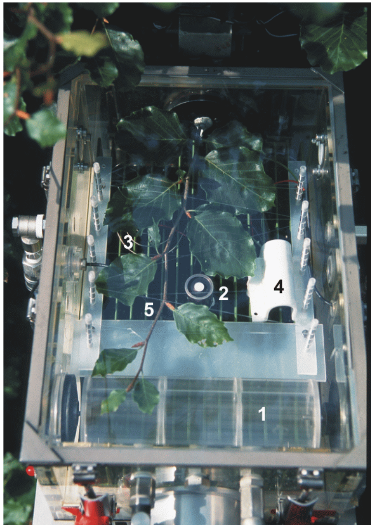
Abb. 2-9: Stationäre Gaswechsellküvette mit eingebautem Buchenast im Kranzberger Forst. 1 = Querstromlüfter; 2 = PAR-Sensor; 3 = Blatttemperaturfühler; 4 = Küvetteninnentemperatur-Sensor unter Abdeckung; 5 = Kühlrippen der Peltierelemente zur Temperaturklimatisierung der Küvette.
