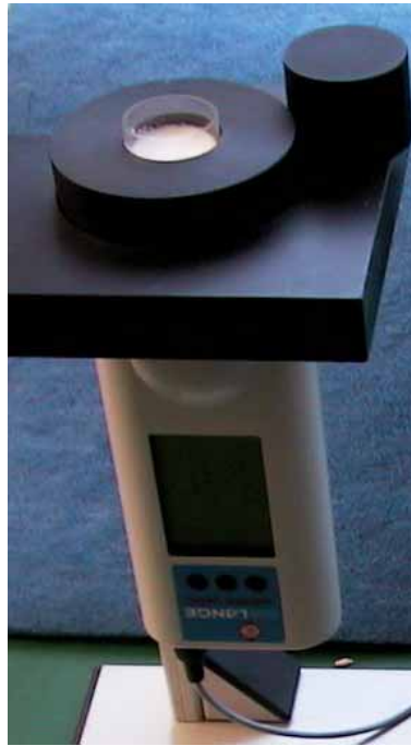
Abbildung 10: Messung der Milchproben mit dem spectro-color® im Überkopfverfahren
