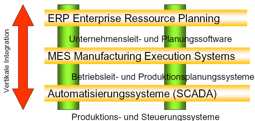
Bild 3.2: Vertikale Integration SCADA-MES-ERP [68]
