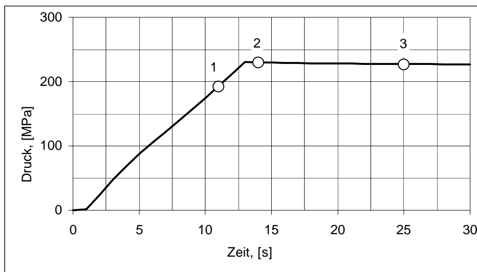
Bild 4.12 Zeitlicher Druckverlauf in Wasser bei einer Ausgangstemperatur von 56 °C mit Kennzeichnung der drei analysierten Momentaufnahmen
