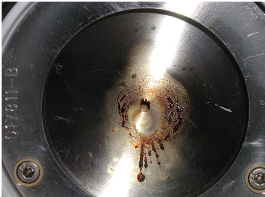
Abbildung 5.3.1 Verschmutzung der „curtain plate“ des API 2000 nach Injektion von ungereinigten Probenextrakten
