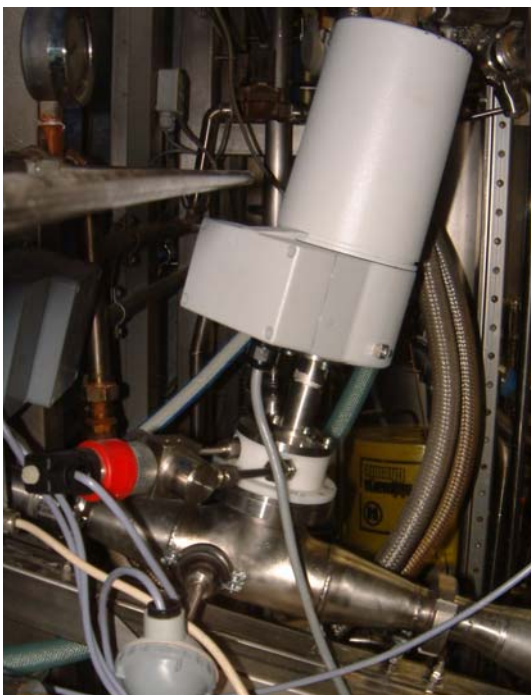
Abbildung 2-2: Prozessviskosimeter (links) sowie Leitfähigkeits- und pH-Sensor (rechts) in der Meßstrecke.
