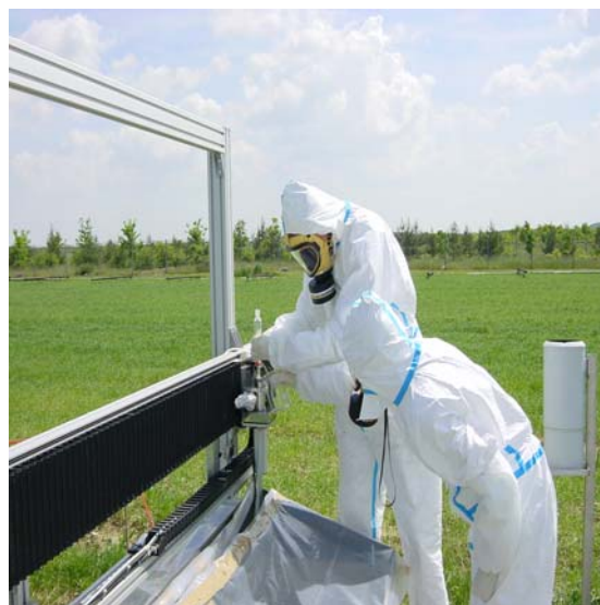
Abbildung 2.6: Vorbereitung der Applikation von ^{14}\text{C} -Isoproturon im 1. Lysimeterversuch (2001). Bild 1): Applikationsvorrichtung mit Linearmotor und Spritzschutz um die Lysimeter. Bild 2): Füllen der Spritzdüse mit ^{14}\text{C} -Arelon-Standardlösung.
