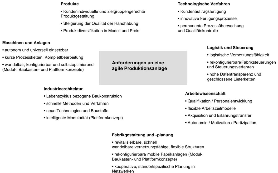
Abbildung 6: Spezielle Anforderungen an die Produktionsanlage (Wirth 2001)
