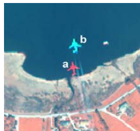
Abb. 18: Das Flugzeug in der IKONOS Szene zeigt den Zeitversatz zwischen PAN-Kanal (a) und den multispektralen Kanälen (b)
