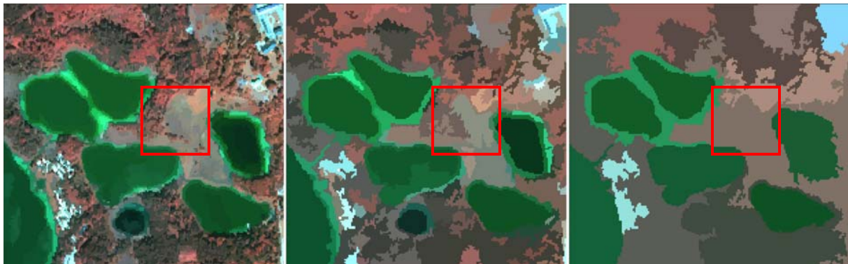
Abb. 10: Segmentierung auf unterschiedlichen Maßstabsebenen. Links: Originalbild; Mitte: Kleine Objekte; Rechts: Große Objekte → kleiner Maßstab. Der rote Kasten zeigt als Beispielobjekt ein Feuchtgebiet
