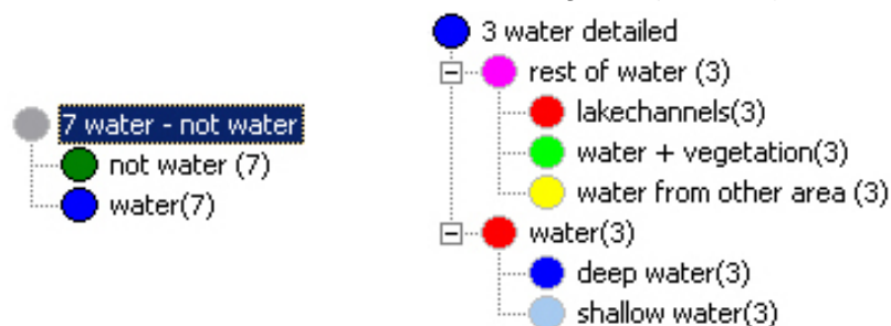
Abb. 33: Level 7 und 3 – Links: Wasser Vorklassifikation; rechts: Detaillierte Reklassifikation auf niedrigerem Level; CASI-Daten. Der Wert in Klammern gibt die Segmentierungsebene an, 3 = Level 3
