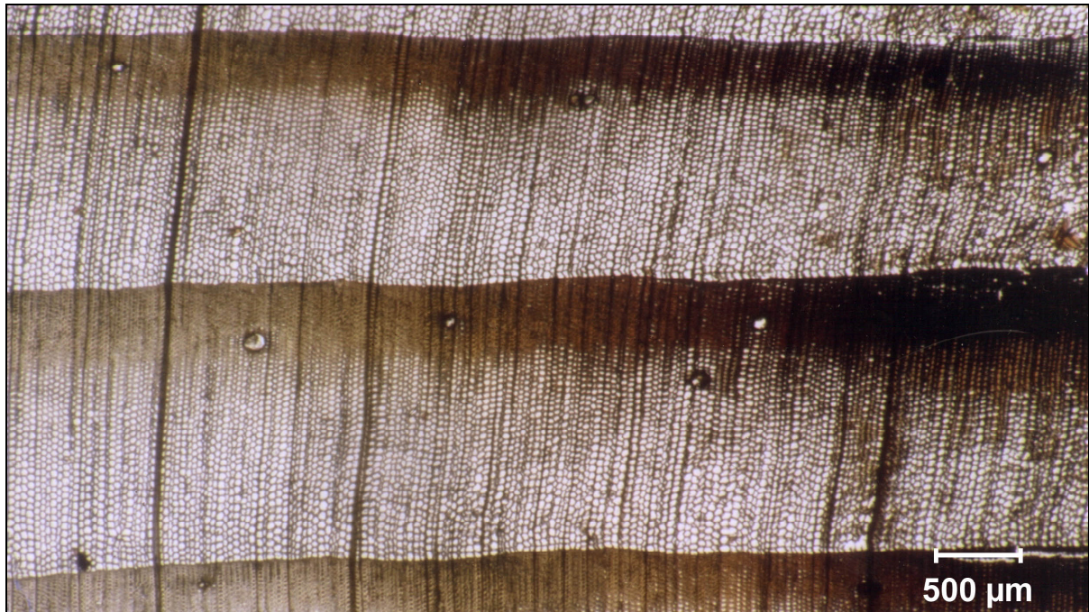
Abb. 22: Lichtmikroskopische Aufnahme der Veränderung von Fichtenholz unter Brandbelastung (Schnittdicke: 35 µm). Der etwa 8 mm breite Querschnitt entspricht einem Temperaturintervall von etwa 150 (links) bis 300 °C (rechts).
