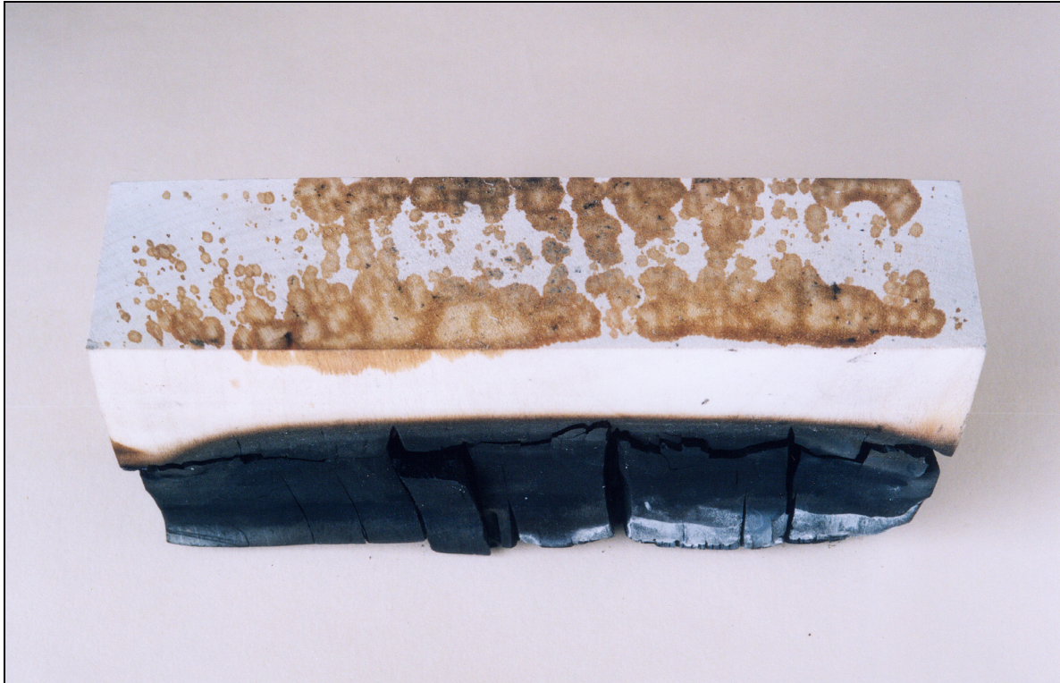
Abb. 28: Hirnseitig beflamnte Ahornkleinprobe nach 60minütiger Brandbelastung. Durch die Hitze wurden Abbauprodukte in Faserrichtung durch das Holz getrieben und auf der Probenrückseite abgelagert.
