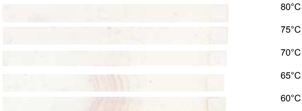
**Abb. 22: IEF-PAG-Pherogramme der Esterase-Isozyme von 5 min bei 60, 65, 70, 75 und 80°C erhitztem Fettgewebe der Pute nach Darstellung mit NA**
