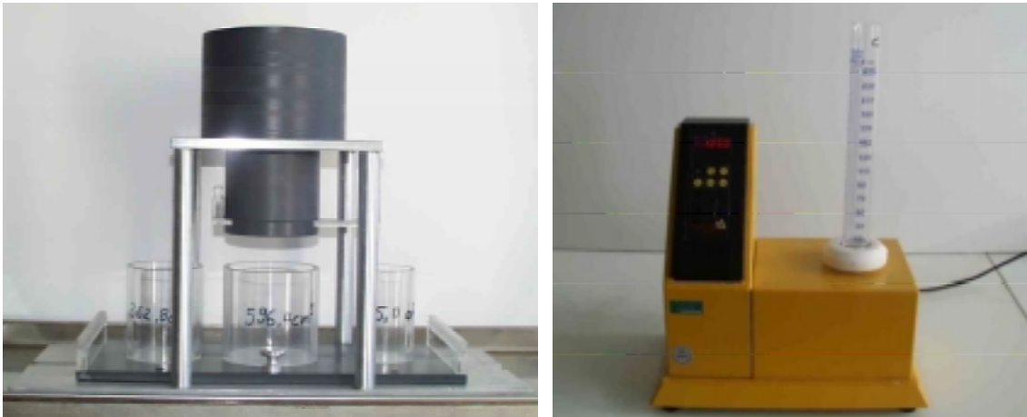
Abbildung 29: Vorrichtungen zur Bestimmung der Schüttdichte (links) und der Stampfdichte (rechts)
