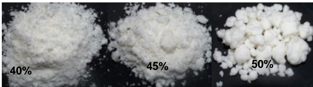
Abbildung 60: Maltodextrin Paselli MD 6 mit verschiedenen Mengen Triacetin
