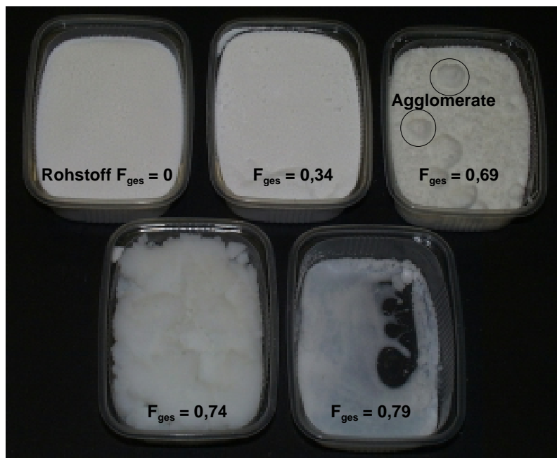
Abbildung 128: Sipernat 2200 mit verschiedenen Feuchten F_{ges}
