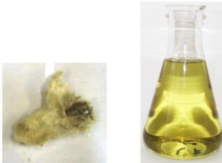
**Abbildung 41:** Getrocknete Coffeinkristalle (links), filtrierter Extrakt (rechts)
