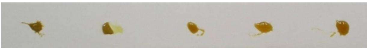
**Abbildung 84: Extrakte, hergestellt bei 700 bar, Aluminiumoxidzugabe von links nach rechts steigend**
