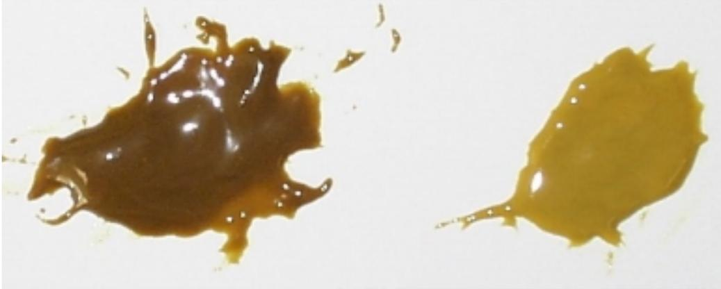
**Abbildung 97: Extrakt ohne (links) und mit 62,5 % Adsorbens bei 700 bar und mit 12,5 % Modifier hergestellt**
