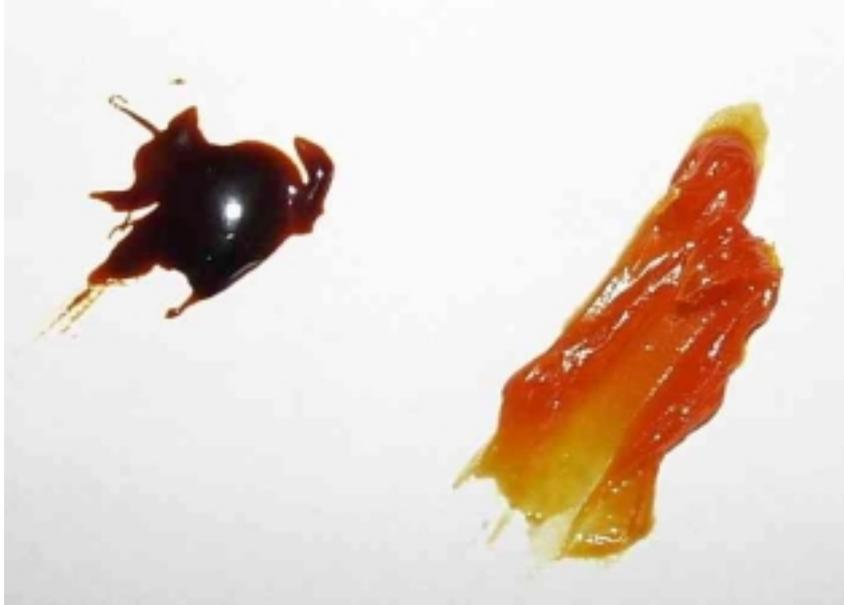
**Abbildung 58:** Extrakte (getrocknet), hergestellt mit 800 bar Extraktionsdruck bei CO<sub>2</sub>-Fließrichtung von oben nach unten.
