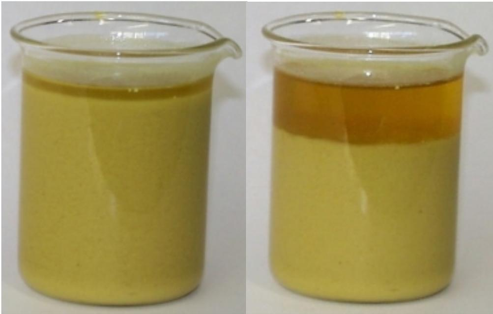
Abbildung 93: Extrakt, hergestellt mit Modifier (12,5 %), nach der Extraktion (links) und nach 30 min
