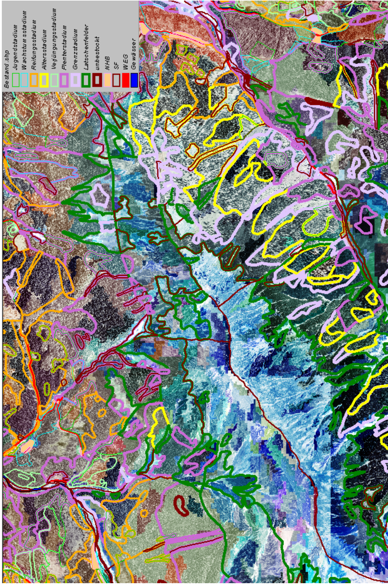
Abbildung 7.4-1; Indikatorwerten im Zusammenhang mit Forst-GIS Polygone können zur weitere Analysen führen. Dieses Detail aus Abb. 6.2.3-12 zeigt wie Komplex das Verhältnis zwischen die vorhandene Vegetation und des Forst-GIS ist. Jedoch allgemeine Trends sind sofort erkennbar, Blautöne z.B. treten nur in unbestockte Flächen auf (Varianz des Mittlr. Infrarot höher als NIR und Rot).
