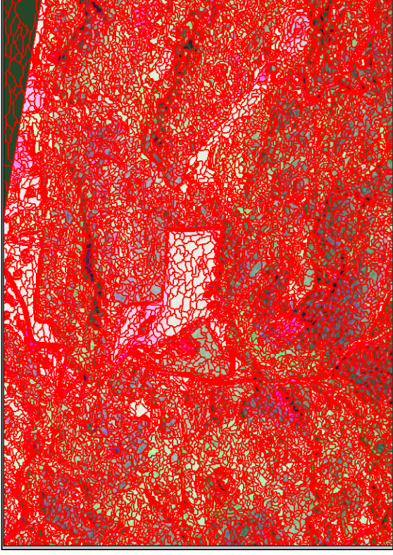
Abbildung 6-1-2 -2: Darstellung aller Objekt-Primitiven (, object primitives') als rote Polygone. Homogene Areale erzeugen größere Objekte.
