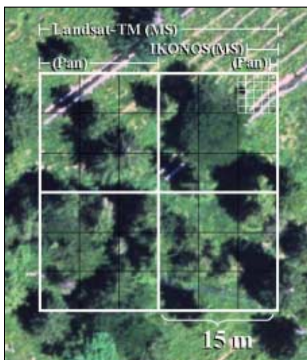
Abb. 4.1: Darstellung des Verhältnis eines Waldobjekts zu der Bildelementgröße des Landsat- und IKONOS-Sensors im multi-spektralen (MS) und panchromatischen (Pan) Bereich. (weitere Erläuterungen s. Text)
