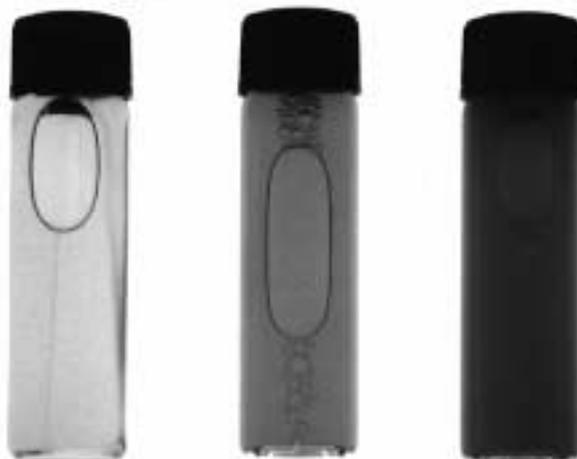
**Abb. 8-6:** Aufgenommenes Bild von Ausgangs- (mitte), Spumat- (rechts) und Rückstandsprobe (links) eines wässrigen Extraktes vom Kurkumapulver
