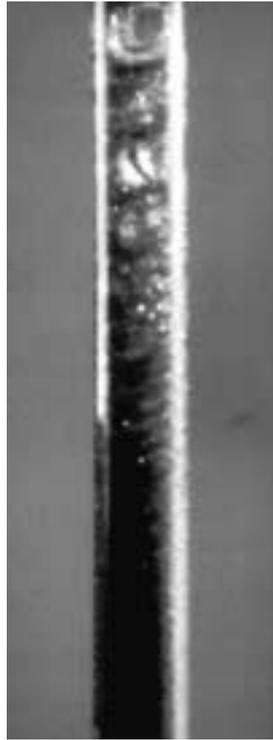
**Abb. 8-3:** Schaumzerfall aufgrund der Gasblasenkoaleszenz und Disproportionierung am oberen Teil der Schaumsäule gegen Ende der Zerschäumung.
