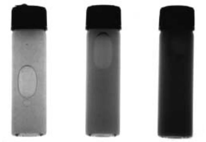
**Abb. 8-4:** Aufgenommenes Bild von Ausgangs-(mitte), Spumat-(rechts) und Rückstandsprobe (links) eines Orangensaftes
