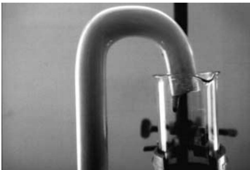
**Abb. 8-2:** Austritt und Sammeln des mit Patentblau angereicherten Schaums (Spumat) aus der Zerschäumungskolonie
