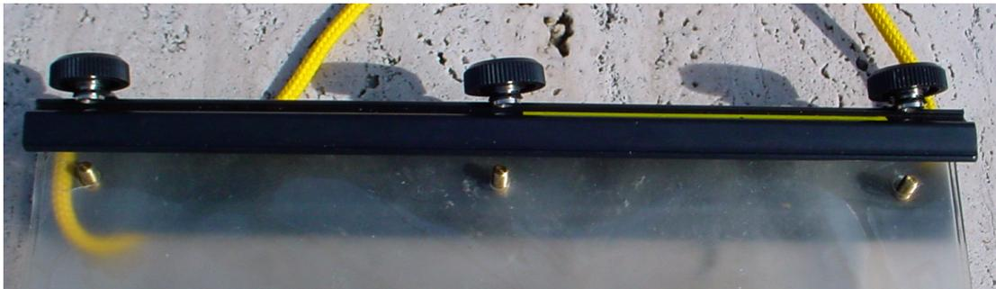
Abb. 50 Spezielle Verschraubung am Taschenausgang
