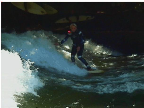
Bei den durchgeführten Messungen wird mit Hilfe einer Triggerlampe, Synchronisationslampe und ihrer Fernbedienung ein gemeinsamer Aufzeichnungspunkt festgelegt. Durch die Betätigung der Fernbedienung wird an der Empfangslampe, die sich an der rechten Schulter der Testperson befindet, ein rotes Licht eingeschaltet. Dieses Licht (siehe Abb. 55) kann
