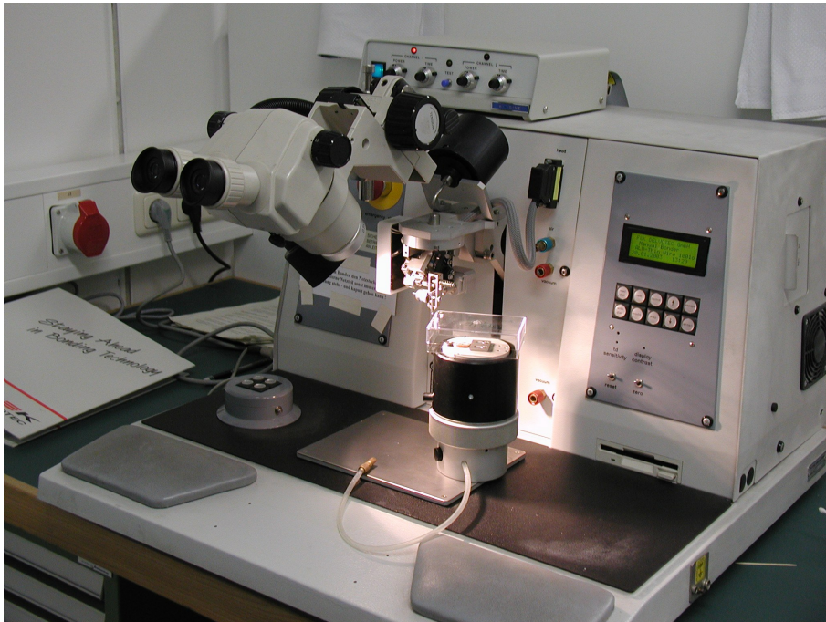
Abbildung 7.17: Delvotec Bonder zum Kontaktieren der Proben
