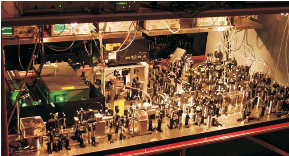
Abbildung 9.2: Fotografie des Lasersystems. Auf der linken Seite sind das Diodenlasersystem (vorne) bzw. das Titan-Saphir-Lasersystem (hinten) zu erkennen. Im mittleren Bereich werden die Strahlen beider Laser aufgeteilt und durch akusto-optische Modulatoren in ihrer Frequenz verschoben. Schließlich gelangen die Strahlen durch mechanische Verschlüsse auf der rechten Seite zur Vakuumapparatur.
