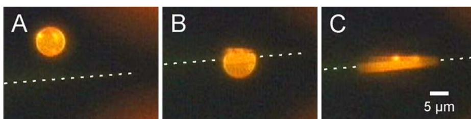
**Abbildung 2.52:** Herstellung einer Barriere aus Lipid auf einer Pipette, um das Spreading zu begrenzen. Da die Poly-L-Lysin beschichtete Pipette fast unsichtbar ist, wird sie durch eine weiße gestrichelte Linie gekennzeichnet. **A:** Eine Pipette befindet sich unmittelbar neben kleinem Minivesikel. **B:** Minivesikel ist an die Pipette adhärert **C:** Der Vesikel ist geplatzt und hat sich komplett auf der Pipette verteilt.
