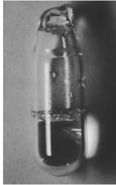
Abbildung 3.8: Abgefüllte und abgeschmolzene Küvette. Die Substanz Calcium-Rubidium-Nitrat ist bei Raumtemperatur ein Glas und bleibt deshalb in der abgeschreckten Form über Monate erhalten.
