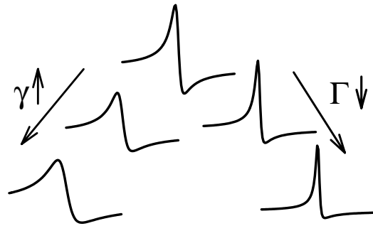
Abb. 6.26: Allgemeine spektrale Form einer Fanoresonanz nach [Mar98]. Links: zunehmende Verbreiterung \gamma des diskreten Niveaus. Rechts: Abnahme der Kopplungsstärke zwischen diskretem Zustand und Kontinuum.
