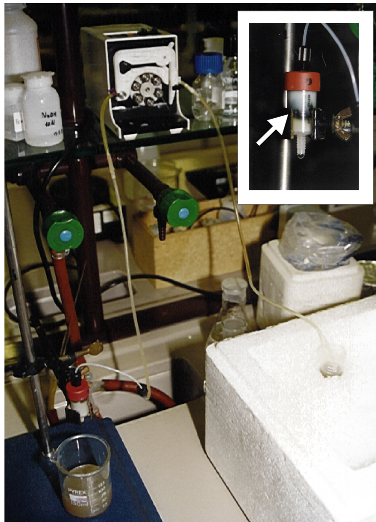
Abb. 4.6 Proteinreinigung auf der HiTrap-Säule: die auf Eis gelagerte Proteinlösung wird über einen Motor in die mit Nickelchlorid aufgeladene Säule geleitet, an der die HiPIPs (als dunkles Band erkennbar) festgehalten werden; mittels Imidazol wird die Proteinfraktion später abgelöst und von anderen Komponenten der Lösung getrennt aufgefangen.
