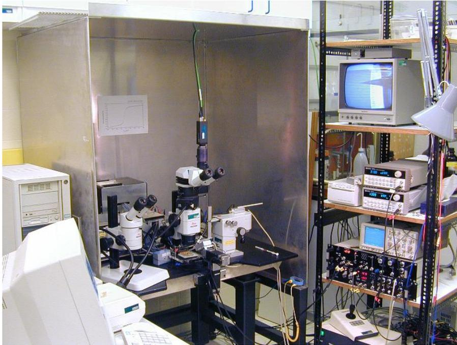
**Bild 4.1:** Experimenteller Aufbau. Die Kopplungsexperimente werden zur Abschirmung gegen eingestrahlte Störungen innerhalb eines Faradaykäfigs durchgeführt. Rechts im Bild das Rack mit der Videoanlage und der Elektronik für die Elektrophysiologie, links der PC zur zentralen Datenerfassung.
