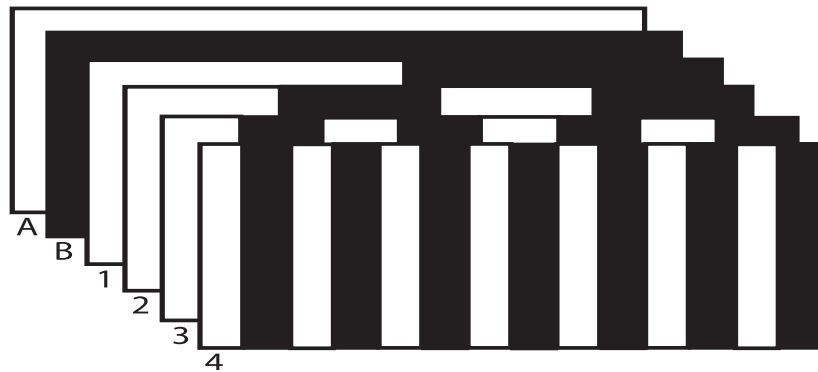
Abbildung 7: Coded Light Teil 1, modifiziert nach B. Breuckmann (1993) [7]
