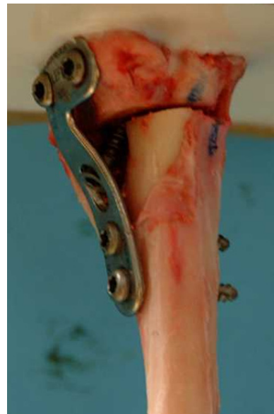
Abbildung 64: frakturierte mediale Kortikalisbrücke (Präparat 4/Gruppe 1)
