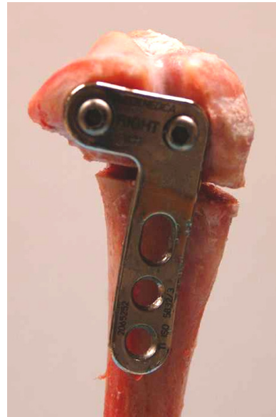
Abbildung 39: Fixieren der L-förmigen HTO-Platte mit zwei Spongiaschrauben
