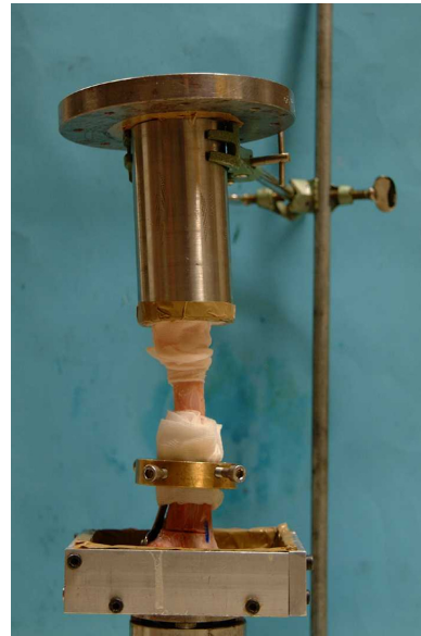
Abbildung 14: Ausrichten des Knochens in der proximalen Einbettform von p.a. gesehen
