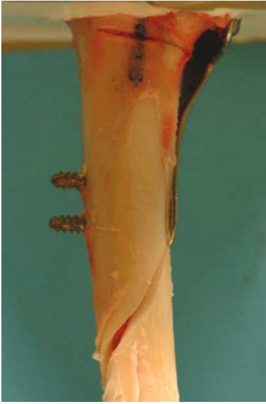
Abbildung 67: teilfrakturierte Kortikalisbrücke, Spiralfaktur Tibiaschaft (Präparat 5/Gruppe 1)
