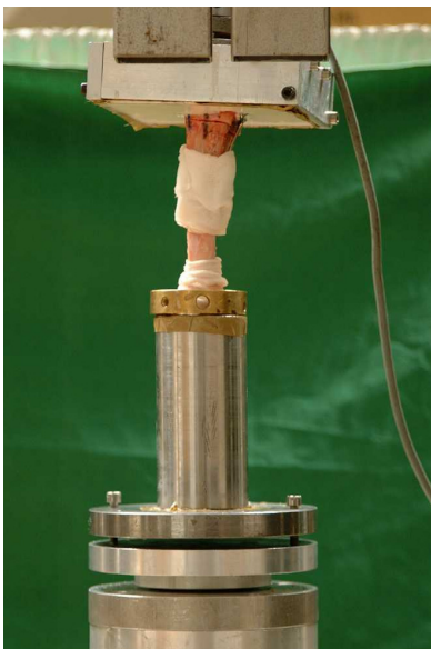
Abbildung 21: vorläufige Verbindung der distal angebrachten Platte mit der Drehmomentdose
