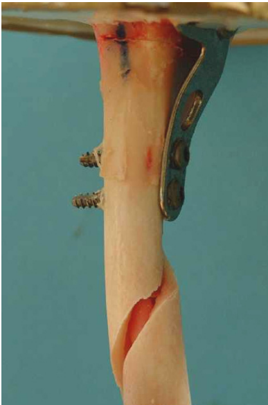
Abbildung 69: teilfrakturierte Kortikalisbrücke, Spiralfraktur Tibiaschaft (Präparat 7/Gruppe 2)
