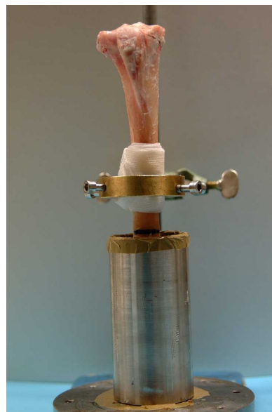
Abbildung 10: Ausrichten des Knochens in der distalen Einbettform von a.p. gesehen
