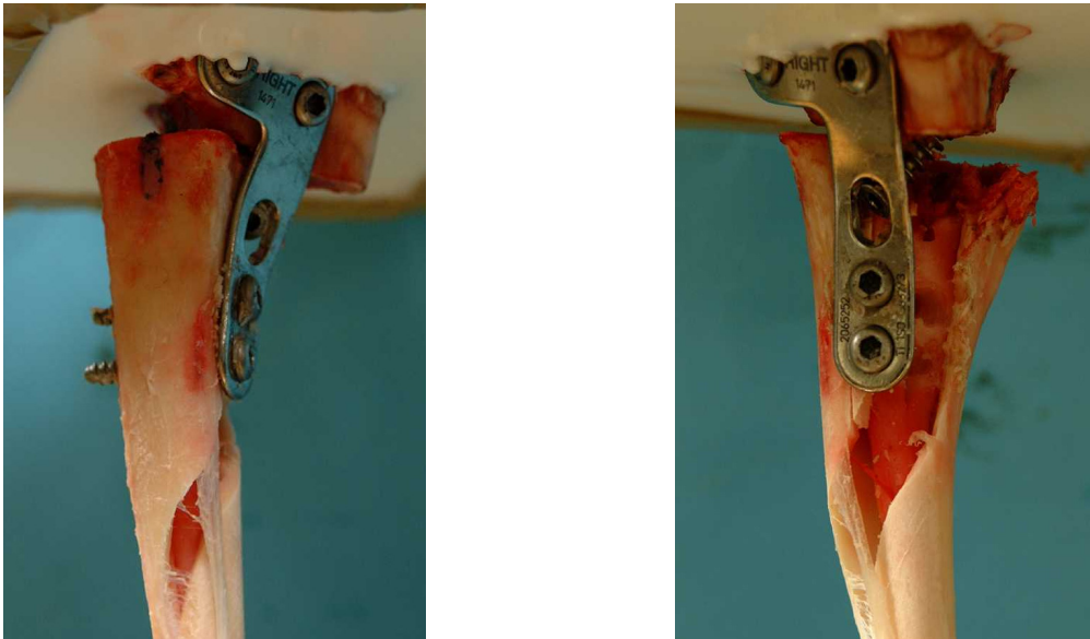
Abbildung 23: Dokumentation des Knochen- und Implantatstatus nach Beenden des Versuches
