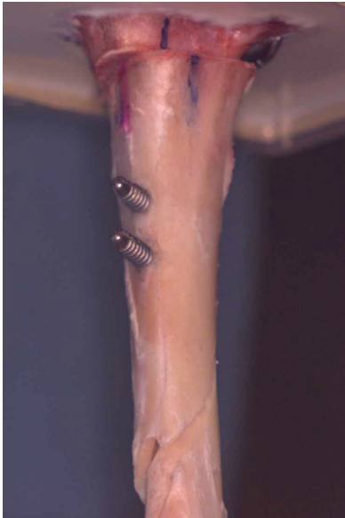
Abbildung 73: Verdrehen der Osteotomie und Schafffraktur (Präparat 8/Gruppe 4)
