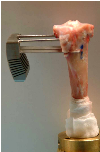
Abbildung 32: Anbringen der schrägen Sägelehre
