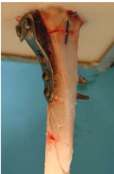
Abbildung 66: intakte Kortikalisbrücke, kompensatorische Spiralfaktur (Präparat 3/Gruppe 1)
