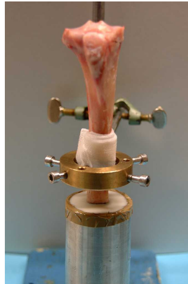
Abbildung 12: Aushärten des Epoxidharzes in der distalen Einbettform
