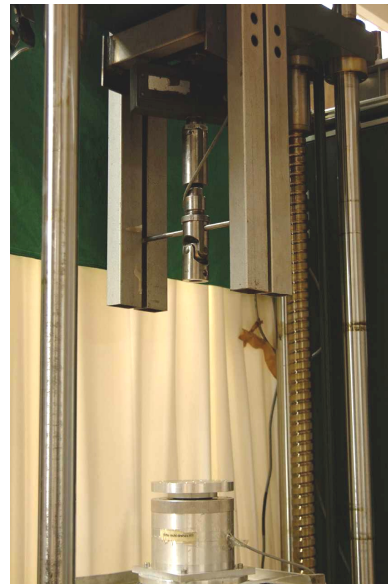
Abbildung 18: Drehmomentdose, Kraftmessdose, Gelenk zum Fixieren der proximalen Einbettform
