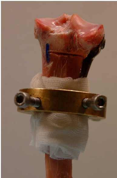
Abbildung 13: Fixierungsring für die Ausrichtung des Knochens in der proximalen Einbettform
