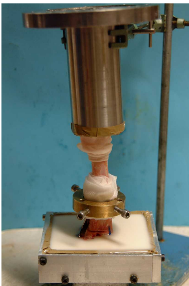
Abbildung 15: Aushärten des Epoxidharzes in der proximalen Einbettform
