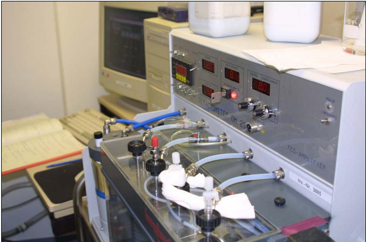
**Abbildung 7.16:** Olfaktometer in Seitenansicht. Dahinter erkennt man den PC mit dessen Hilfe das Olfaktometer bedient wird. Dies ist der Arbeitsplatz des Untersuchers während des Versuchs.
