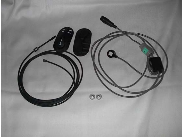
Abbildung 4.5: Tastkopf: Emitter und Detektor
