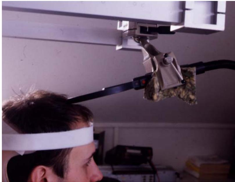
**Abbildung 6** stellt das Metallgestell dar, an welchem die Plastikschale zur Befestigung des Hinterkopfes der Probanden und die Halterung der Magnetstimulationsspule mittels Metallklammern angebracht wurden. Dadurch konnten konstante Bedingungen während des Versuches sichergestellt werden. Die Abbildung zeigt die Spulenplatzierung für die mesiale präfrontale Kontroll-rTMS bei der nur der vordere Spulenrand dem Kopf auflag.
