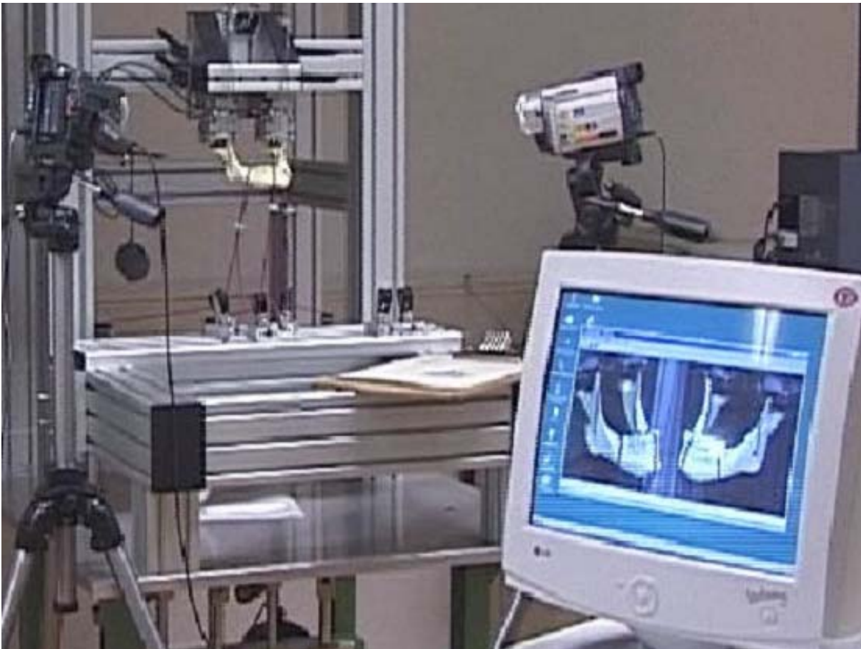
Abb. 16 Versuchstand mit hydraulischen Antrieben und Bewegungserfassungssystem
